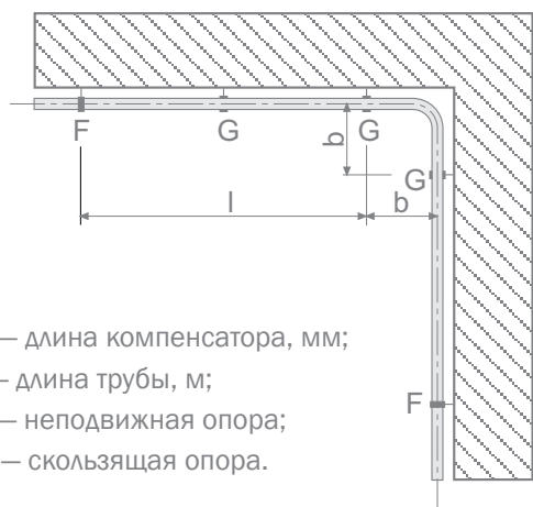
Пример оборудования компенсатора при смене направления трубопровода
