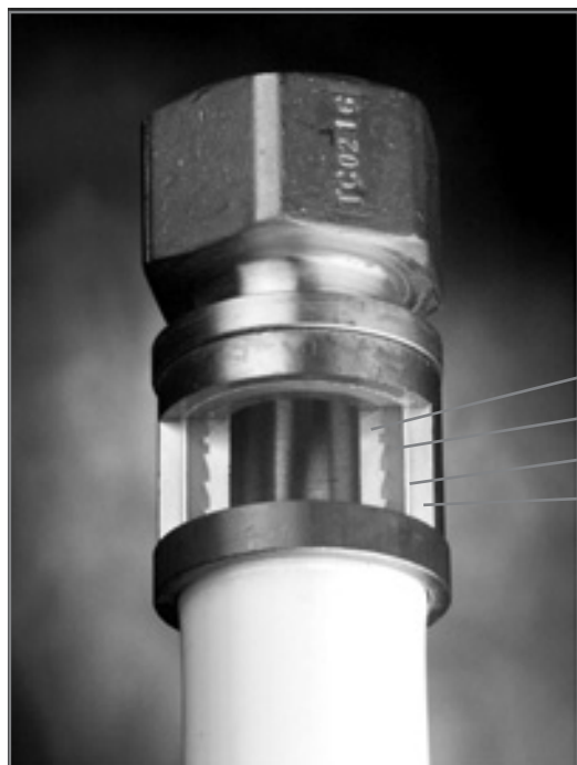
Фитинг Базовая труба Алюминиевый слой Гильза
