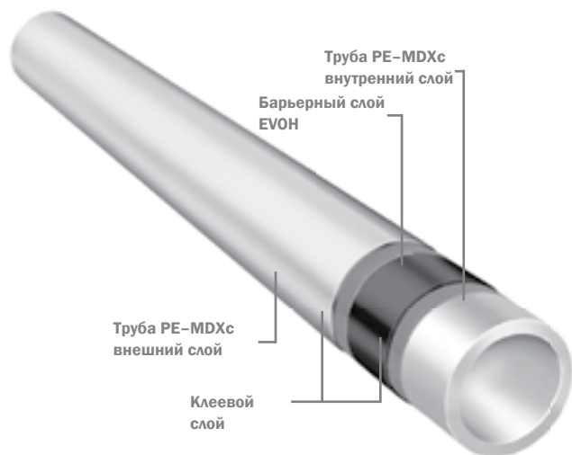
Структура трубы PE-MDXc TECeflex
