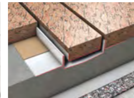
Монтаж с укладкой каменной плиты
