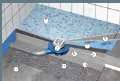
Монтаж основы для плитки на бетонную стяжку (без использования монтажной рамы)
